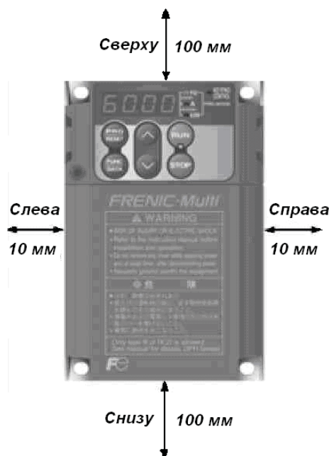
Рисунок 2.1 Положение при установке и необходимые зазоры
