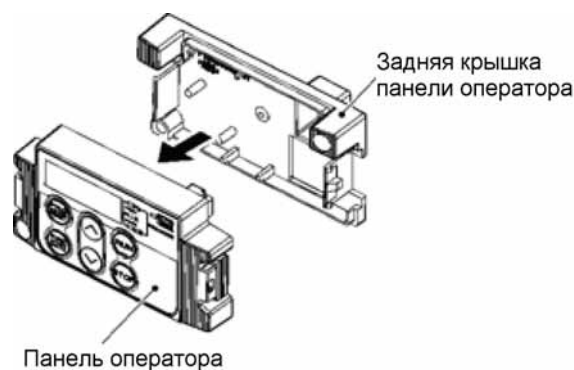
Рисунок 2.27 Установка задней крышки панели для работы на расстоянии
